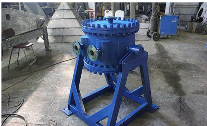
Спиральные теплообменники для нагрева сырой нефти (подготовка к отгрузке)
