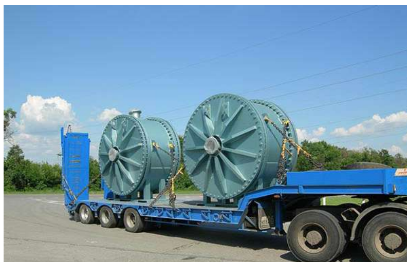
4-х канальные спиральные теплообменники для рекуперации тепла при ректификации нефти
