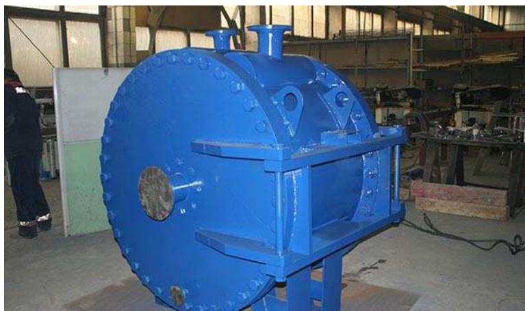
Спиральный теплообменник для охлаждения масла (стадия изготовления – контроль сварных швов методом цветной дефектоскопии )
